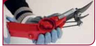
Fig 3 - Régler l'inclinaison de la cisaille
