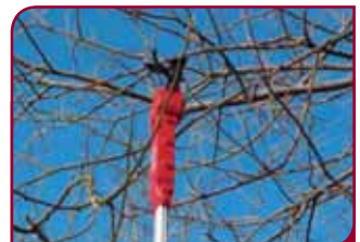
Fig 5 - Acercar la cizalla a la rama
