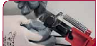
Fig 2 - Régler la longueur de la tige
