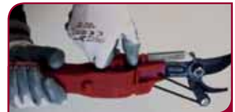
Abb. 3 - Die Neigung der Schere einstellen
