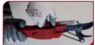
Fig 3 - Regular la inclinación de la cizalla
