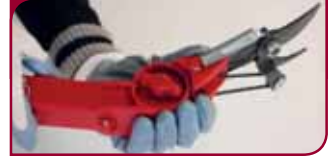
Fig 3 - Regular la inclinación de la cizalla
