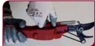
Fig 3 - Régler l'inclinaison de la cisaille
