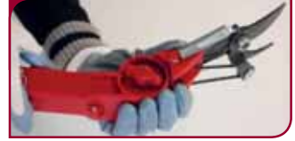
Abb. 3 - Die Neigung der Schere einstellen
